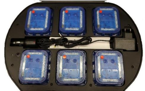
Mientras prueba la Batería, las balizas se están conectando de forma inalámbrica, con un retardo de segundos al encenderse. El destello anterior debe estar parpadeando antes de encender el siguiente destello. El resto se puede hacer de la misma manera.
